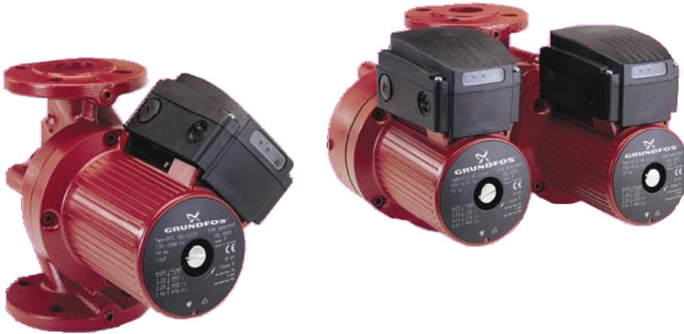
Las bombas circuladoras Grundfos tipo UPS y UPSD están diseñadas para la circulación de líquidos poco densos, limpios, no agresivos ni explosivos, sin partículas sólidas, fibras o aceite mineral en sistemas de calefacción y sistemas de refrigeración y aire acondicionado. En sistemas de agua caliente sanitaria se recomienda utilizar bombas de bronce.
